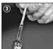
3. В счётчик пузырьков пипеткой накапать водопроводной воды, заполнив ею  $\frac{3}{4}$  его объема. (3)
