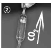
2. Счётчик пузырьков и обратный клапан соединить отрезком шланга длиной приблизительно 5 см. Выходное отверстие счётчика пузырьков должно быть обращено к направлению потока! (2)
