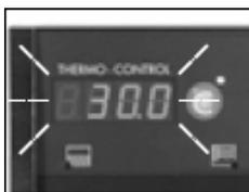
Индикатор мерцает, если температура в аквариуме отклоняется от требуемого температурного значения более чем на +3 или -3°C
