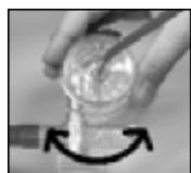
До упора влево (по часовой стрелке): крышка для выпуска фальшивых газов максимально открыта, о чём свидетельствуют выходящие из него крупные пузыри. Чем больше поворачивается крышка против часовой стрелки, тем меньше становятся пузырьки. Если повернуть до упора вправо, крышка закроется. Следите за соответствующим символом на крышке
